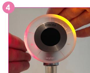
4 Aktivieren Sie kurz nacheinander die Sektoren "Desinfekt" und "+" am Auslauf. Die Spülfunktion beginnt und endet nach 45 Sekunden automatisch. Der Desinfektionsschlauch wird entleert.
