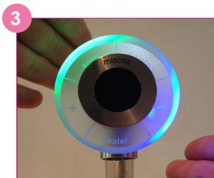
3 Aktivieren Sie kurz nacheinander die Sektoren "Seife" und "-" am Auslauf. Die Spülfunktion beginnt und endet nach 45 Sekunden automatisch. Der Seifenschlauch wird entleert.
