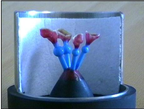
Ein homogener Guss hängt sehr stark von der richtigen Dimensionierung der Gusskanäle und der Versorgungskanäle ab.
