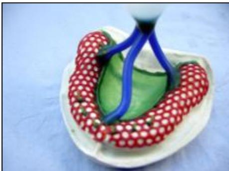
Wenn eine Modellation nicht mit 2 Gusskanälen so versorgt werden kann, dass alle Volumensteile versorgt werden (Klammermodellguss, Gaumenplatte), können zusätzlich Nachsaugkanäle angebracht werden. Hier ist der Durchmesser eines Nachsaugkanals von 3 mm ausreichend.
