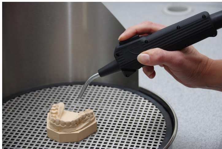
Abb.: Haltung der Pistole für detaillierte Reinigung
