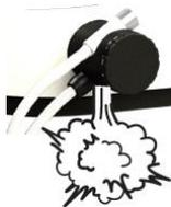
**Unterhalb des AIRFLOW®-Handstückschlauchsystems tritt Pulver aus**
